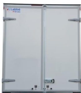
Fermeture par 2 portes arrière battantes version simple
